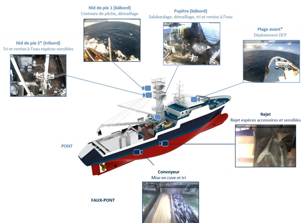
Figure 2 : Schéma d'installation des caméras à bord des thoniers senniers de la CFTO sur le pont (caméras extérieures en bleu foncé) et dans le faux pont (caméras intérieures en bleu clair). Des exemples de vues associées à chacune des caméras sont présentés avec leur rôle respectif dans le suivi de l'observation électronique. Sur le pont, les caméras Nid de pie 2 et Plage avant ajoutées dans la configuration OceanLive 2 sont présentées avec un astérisque.
