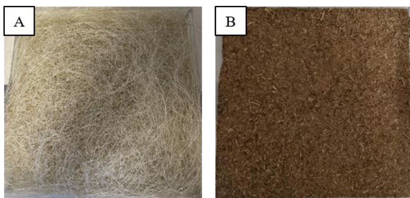
Figure 3. Isolants en vrac à partir de fibres de choka (A) et de broyat de feuilles d'ananas (B).
