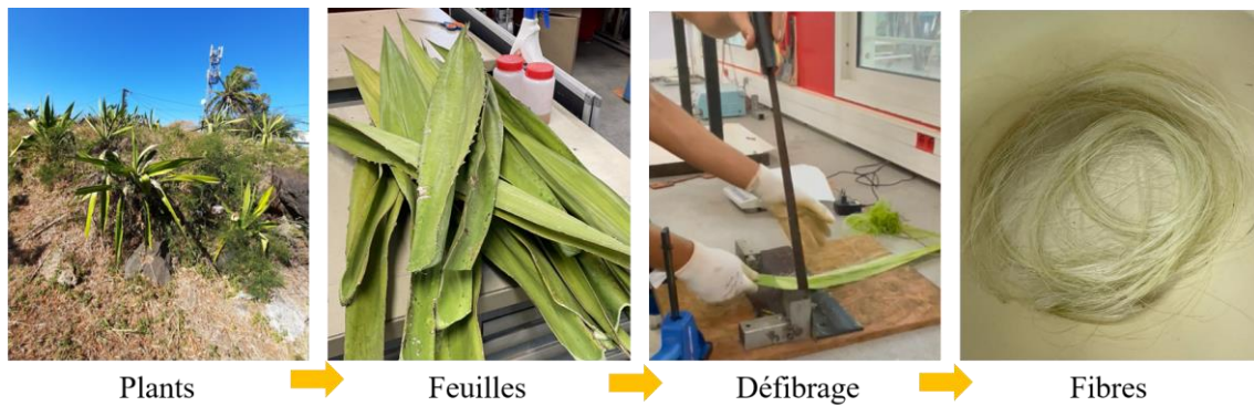
Figure 1. Extraction manuelle des fibres de choka.
