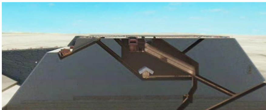
La plateforme de livraison des monolithes à gauche, la Chambre du Roi au centre, le contrepoids dans la GG1 à droite. Cette dernière est couverte à l'exception d'un puits ouvert pour le passage des cordes en partie haute de la GG1. Les équipes de traction opèrent au niveau du plafond à construire au-dessus de la GG1. Le réarmement est effectué à l'aide de la plateforme transformée en contrepoids temporaire.
