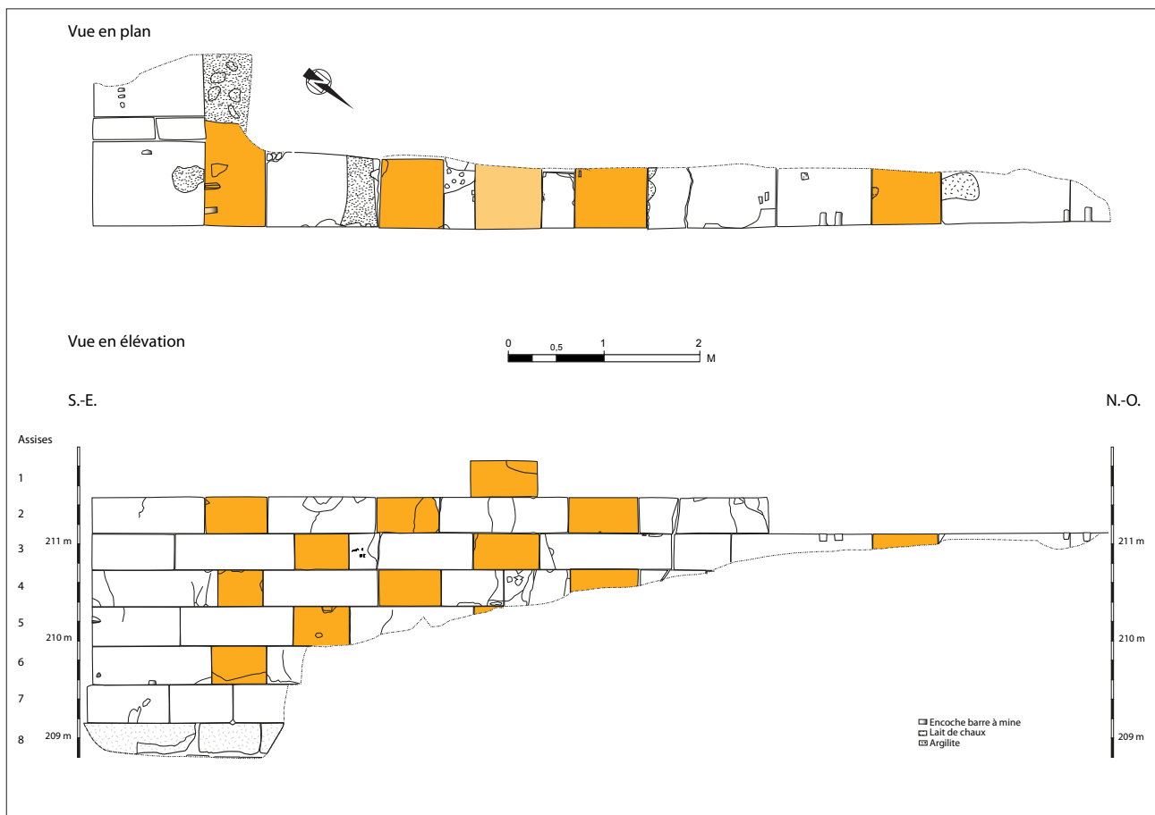
Figure 20 : Mise en évidence des blocs de parement du mur de parodos disposés en boutisse. © Frédéric Gerber, MAFHA 2021.
