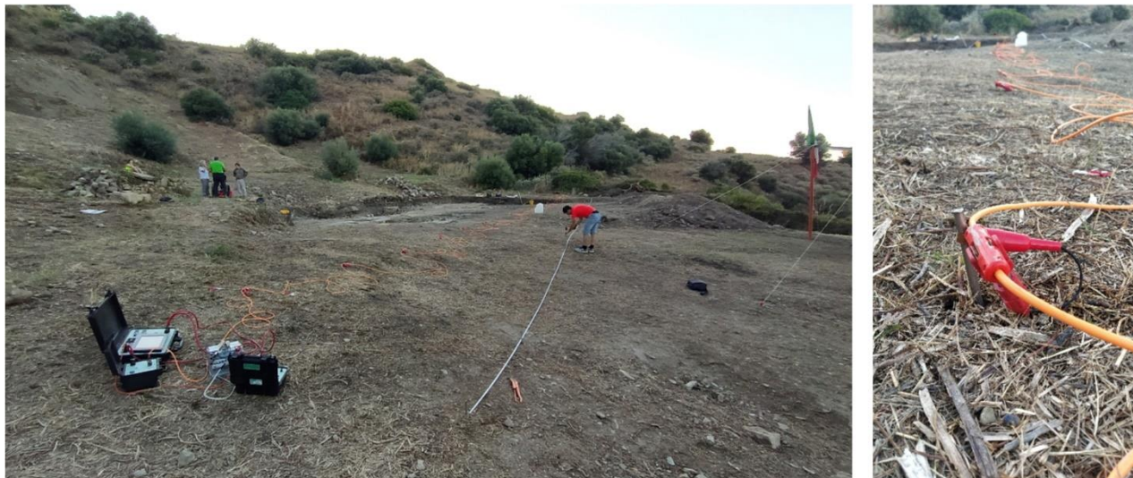
Figura 8-A sinistra alcune fasi dell'esecuzione delle prospezioni geoelettriche; a destra particolare di uno stendimento
