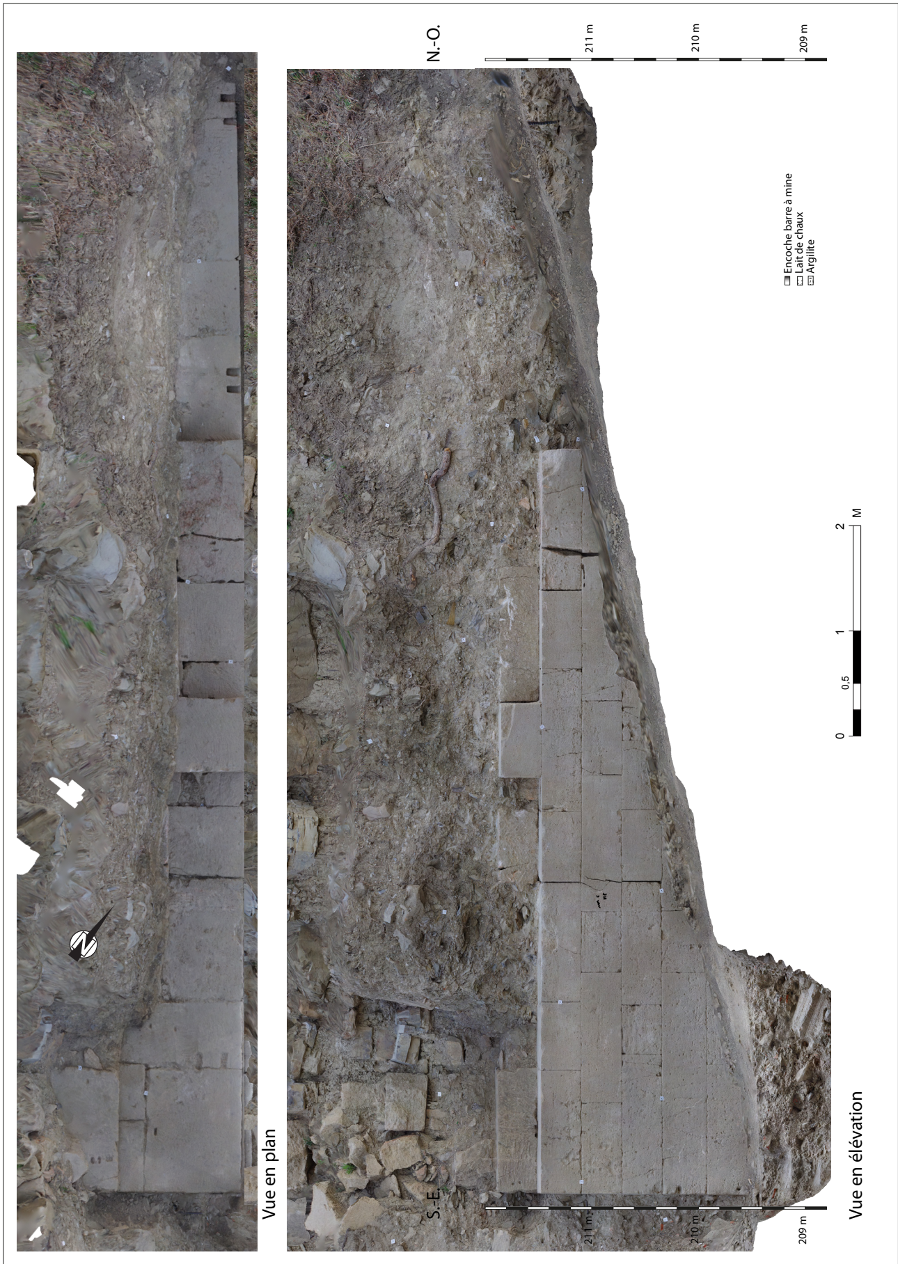
Figure 18 : Relevé orthophotographique en plan et en élévation du mur de parodos méridional. © Prises de vue Frédéric Gerber et Claudie Thierry ; traitement Emmanuelle Meunier ; infographie Frédéric Gerber, MAFHA 2021.
