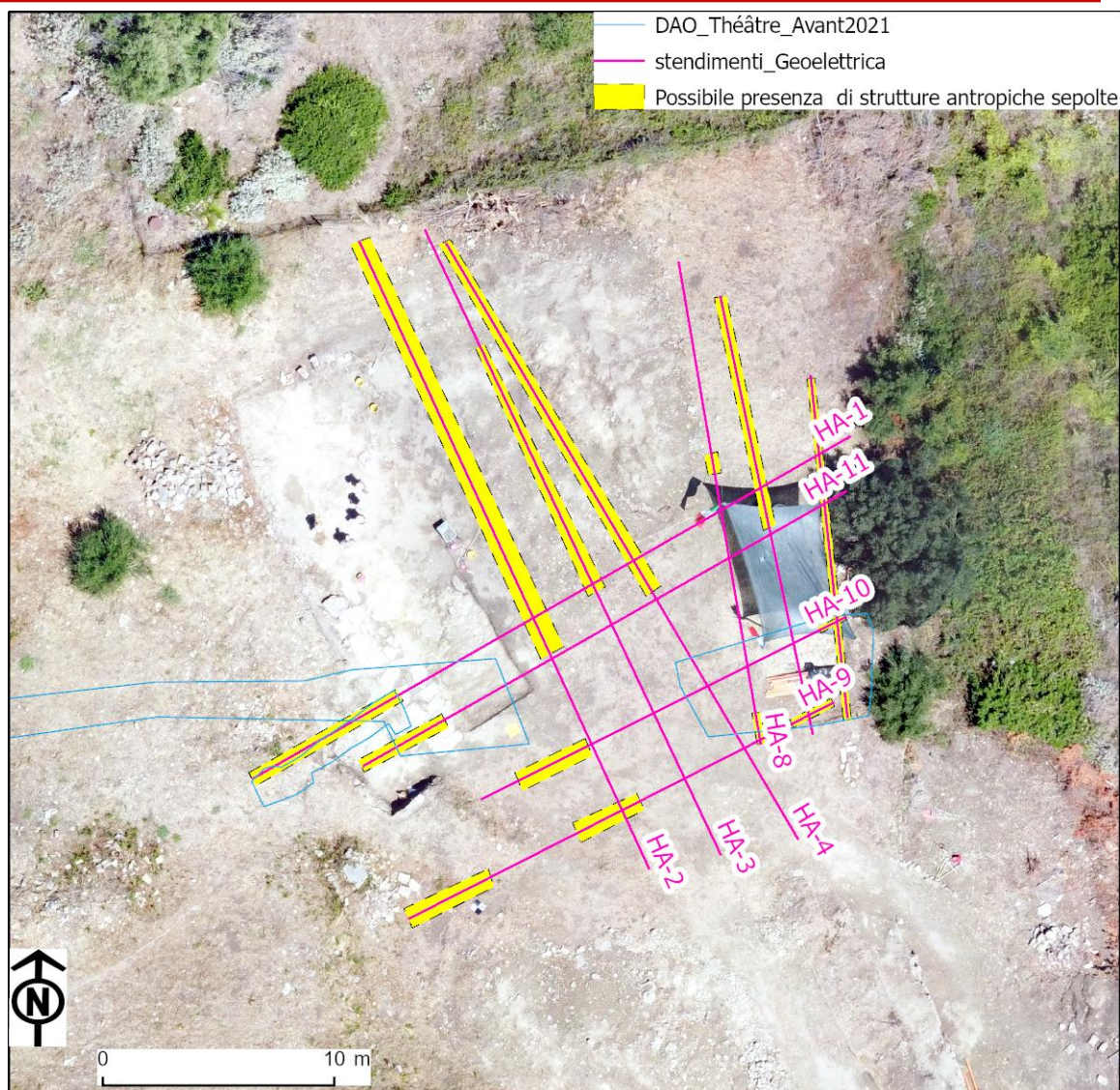
Figura 21-Mappa delle anomalie di origine antropica ipotizzate dalle tomografie elettriche
