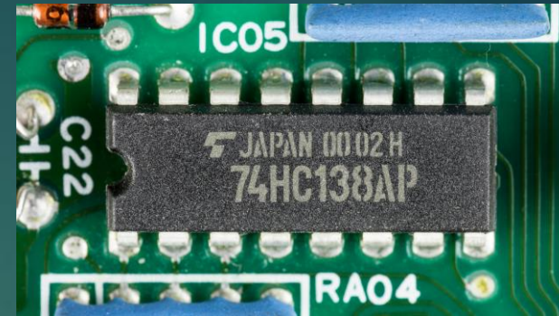
74HC138 : composant DIP démultiplexeur
