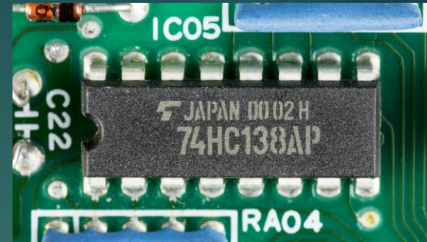
74HC138 : composant DIP démultiplexeur
