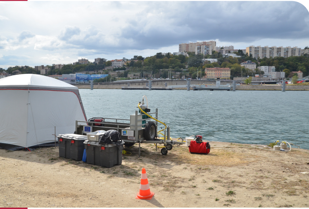
Prélèvement de matières en suspension par centrifugation dans le Rhône, à l'amont de sa confluence avec la Saône à Lyon, afin d'évaluer la qualité chimique des eaux d'une grande agglomération urbaine.
