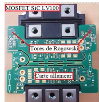
Application/résultats : détections par la réponse temporelle de phases de court-circuit du module LV100 avant dégradations et seuils de destruction.
