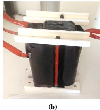
**Figure 4: (a): schéma du MFT prototype avec des distances assurant l'isolation en mode commun du primaire; (b): TMF prototype (Masse=14kg)**
