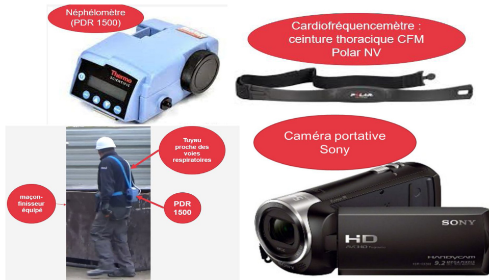
Figure 2. Illustration du matériel utilisé et de sa mise en oeuvre sur le terrain.
