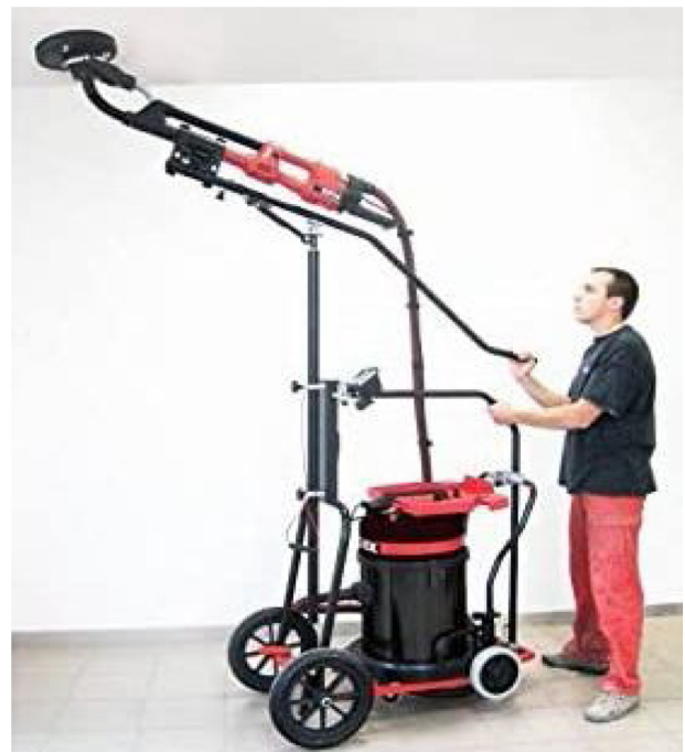
Figure 5. Chariot à tester lors du ponçage de plafond.
