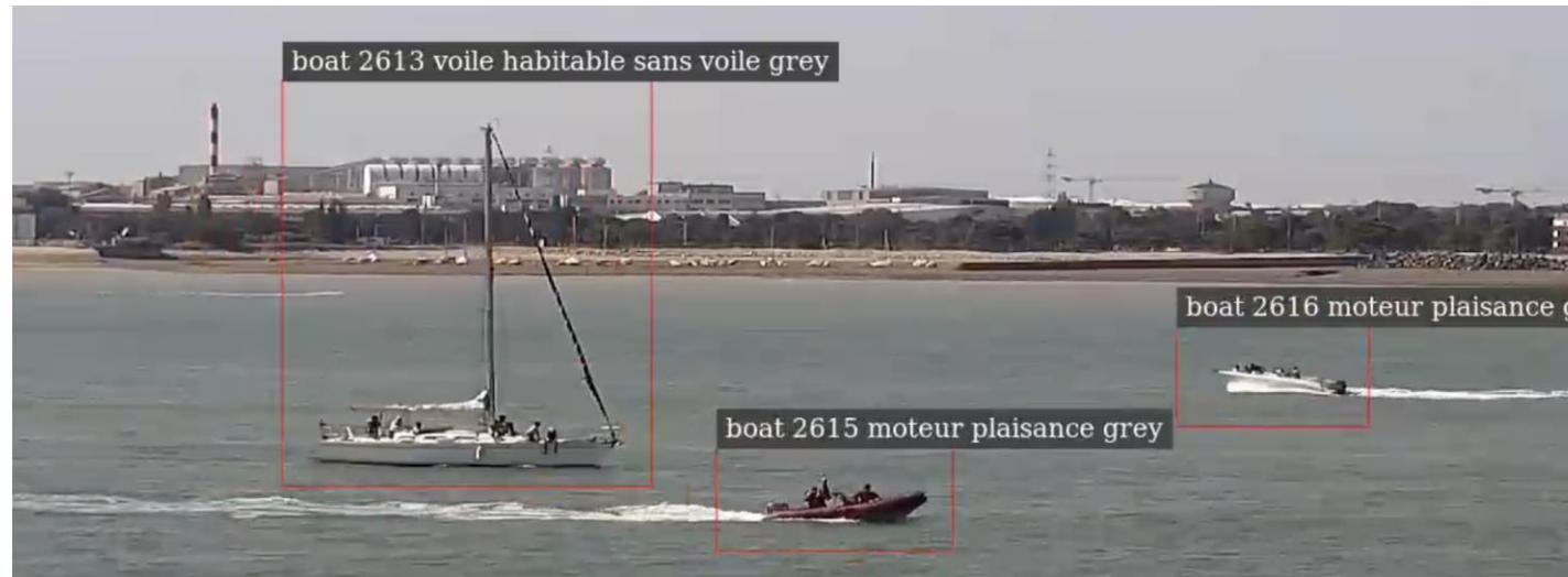
Solution logicielle proposant des trajectoires d'évitement en mer pour des véhicules de surface sans équipage (USV) de type gros porteurs. Prise en compte des règles de navigation.
