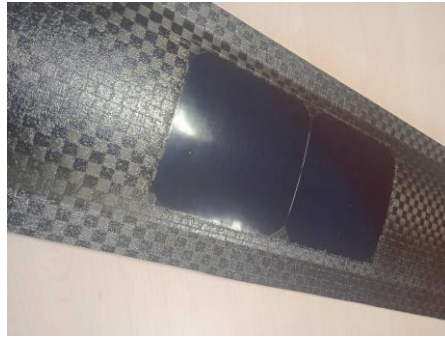
Fig. 3. Eprouvette technique intégrant les cellules photovoltaïques
