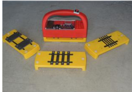
FIGURE 2. Géométries des patins capacitifs développés [Dérobert et al., 2008]
