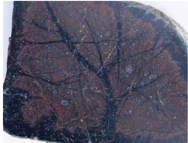
Figure 13 – Péridotite, montrant dans la trame brun rouge de péridot totalement transformé des grenats (de l'espèce pyrope ) globuleux eux-mêmes totalement épigénisés en ce qu'on appelle de la kélyphite . Remarquer l'altération serpentineuse noire pénétrative dans les craquelures de la roche, et la croûte d'altération noire, verte en surface. Section polie, 10 cm. Coll. de pétrographie P. Fluck / Peridotit, der in der braunroten Struktur von vollständig umgewandeltem Peridot kugelförmige Granate (der Pyrop-Art) zeigt, die ihrerseits vollständig zu sogenanntem Kelyphit epigenisiert sind. Beachten Sie die durchdringende schwarze schlangenförmige Verwitterung in den Rissen des Gesteins und die schwarze Verwitterungskruste, die an der Oberfläche grün ist. Geschliffener Querschnitt, 10 cm. Petrographische Sammlung P. Fluck. Photo © P. Fluck
