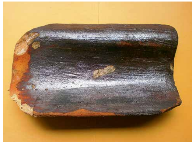
Abb. 3 – Dachziegel, Irdenware, Glasur mit silberhaltigem Bleierz; frühes 19. Jh., Mayen (Süd-Eifel), Bildbreite 35 cm / Tuile en terre cuite; glaçage avec minerai de plomb contenant de l'argent; début 19 e siècle. Mayen (Eifel du Sud). Largeur d'image 35 cm. Foto © N. Knauf
