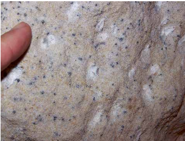
Abb. 5 – „Knottenerz“ („Silberfreier“ Bleiglanz im Sandstein); Grube „Günnersdorf“ Mechernich (D) / «Nodule de galène» dans le grès (non argentifère!). Mine «Günnersdorf» Mechernich (D). Foto © N. Knauf
