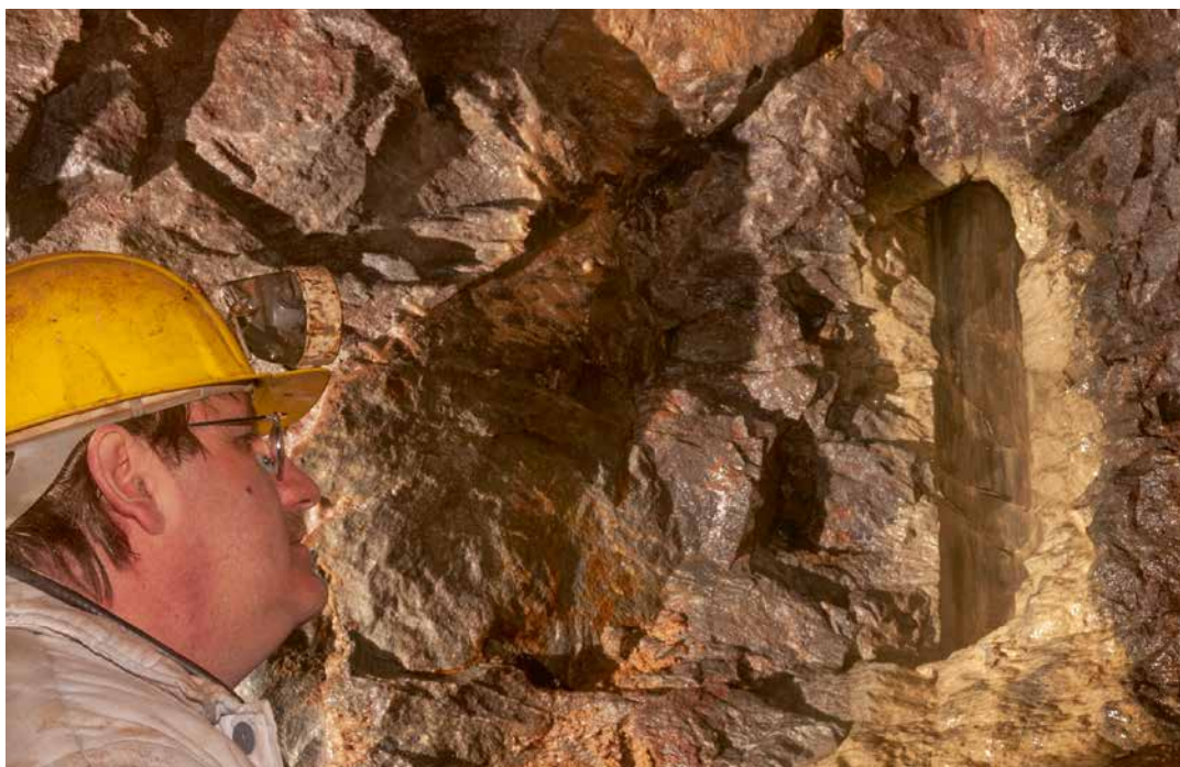
Abb. 18 – Wetterbohrloch / Forage d'aérage . Friedrich Benno Stolln bei Dörnthal. Foto © Jens Kugler
