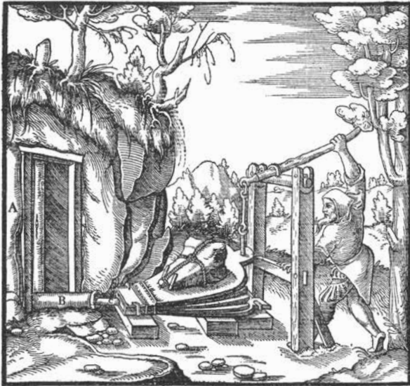
Der Stollen A. Die Rohre B. Das Mundstück des doppelwirkenden Blasebalges C.
