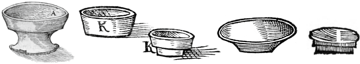
Figure 4 – De gauche à droite / Von links nach rechts : le catillus fictilis d’Agricola (‘A’), deux Probir Schirben d’Ercker (‘K’), le Probier Scherben de Schindler et le treyb scherben de Zimmermann. DAO © J. Gauthier
