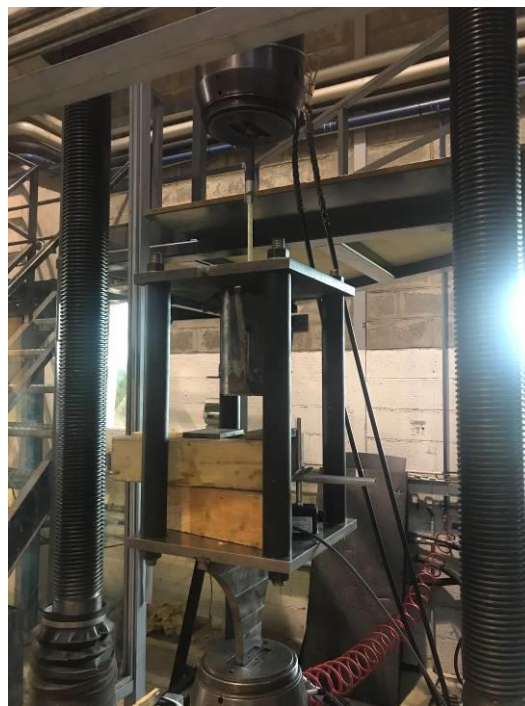
Figure 4 : Essai d'arrachement sur éprouvette « pull-out »
