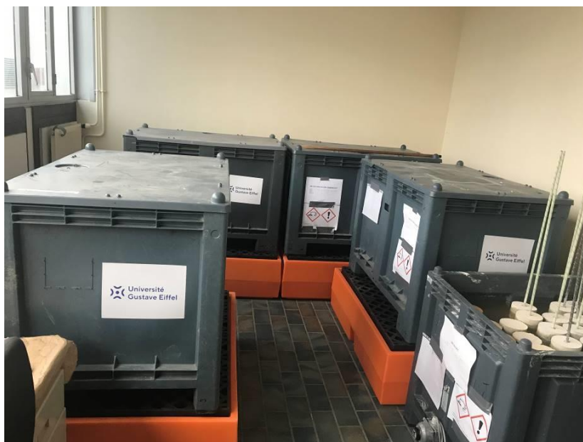
Figure 5 : Salle de vieillissement des éprouvettes (VSC) contenant les bacs thermostatés
