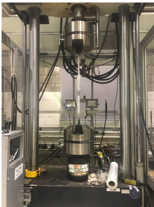
Figure 2 : Essai de traction sur une presse hydraulique
