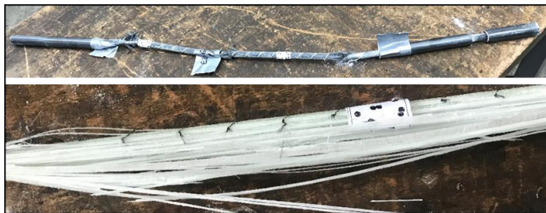
Figure 8 : Modes de rupture des PRFV et PRFC
