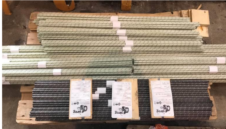
Figure 1 : Armatures PRFV et PRFC étudiées
