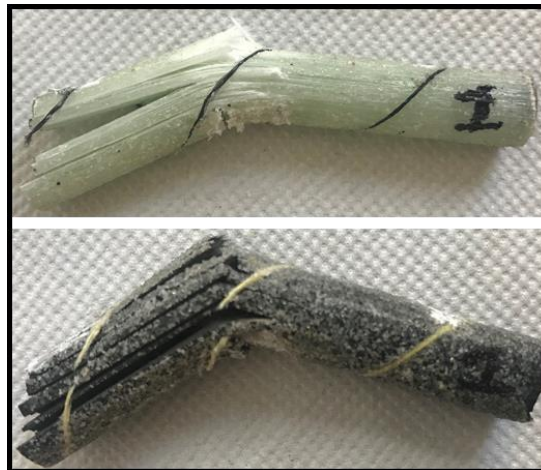
Figure 12 : Modes de rupture des armatures a) PRFV et b) PRFC après un essai de cisaillement inter-laminaire
