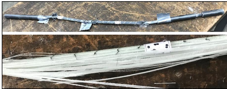
Figure 8 : Modes de rupture des PRFV et PRFC
