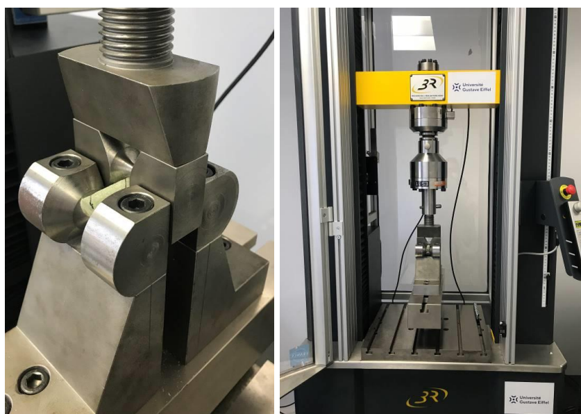
Figure 3 : Essais de caractérisation du cisaillement interlaminaire
