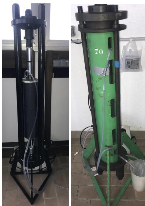
Figure 6 : Bâtis de vieillissement VAC pour les éprouvettes a) de pull-out et b) de traction
