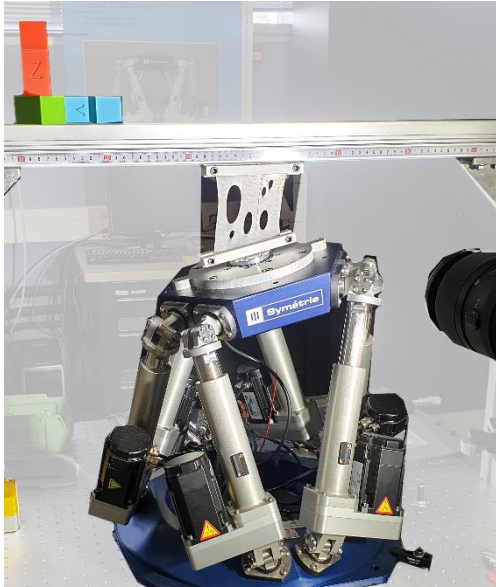
Figure 2- Banc expérimental composé d'un hexapode BREVA Symétrie, de traverses fixes et de mors adaptés à la géométrie des membranes. Une caméra enregistre l'éprouvette en cours de sollicitation.
