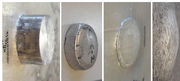
Figure 2. Système de protection multicouche impacté par un projectile en acier à haute résistance, cylindrique à bout plat et de masse 60 g lancé à 227 m/s. De gauche à droite : face arrière de la plaque avant (le projectile est resté bloqué), pastille éjectée, face avant de la plaque arrière, face arrière de la plaque arrière.
