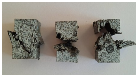
Figure 7. Modes de rupture pour les essais aux barres de Hopkinson.
