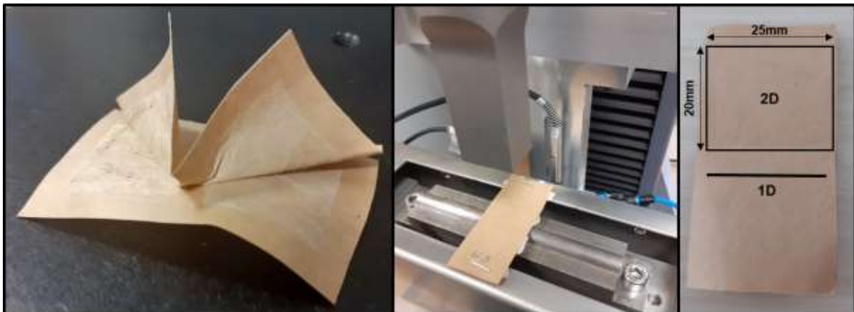
Figure 1 : Papiers soudés partiellement pelés (gauche), échantillon prêt à être soudé (centre), dimensions des échantillons et des surfaces soudés (droite).
