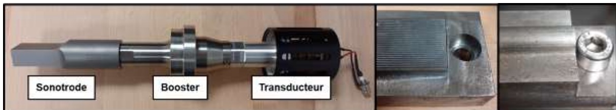
Figure 3 : Composants du dispositif de soudage (de gauche à droite) : ensemble acoustique, enclume n°2, enclume n°1.
