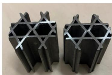
Figure 3 : Structures tri-hexagonales fabriquées par SLM
