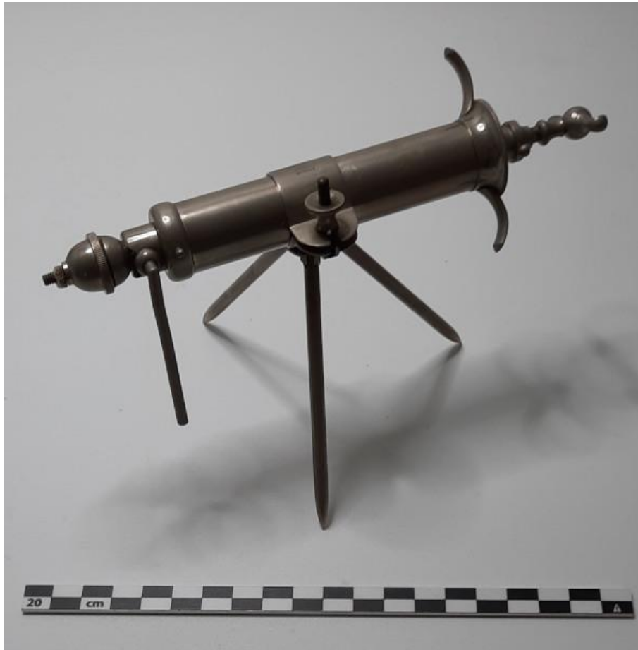
Figure 27 : Seringue à Lipiodol à remplissage latéral et son statif de stabilisation à 3 pieds. Marque Drapier. © Coll. de l'auteur.
