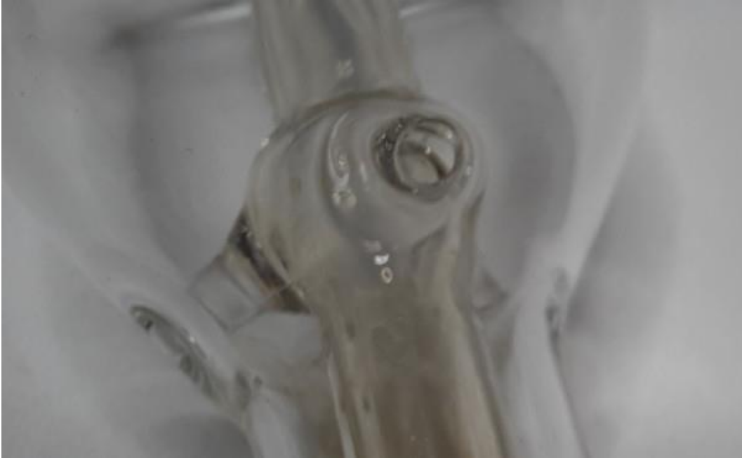
Figure 41 : Détails des ponts de verre centrants la canule dans la partie ventouse. © Coll. de l'auteur.
