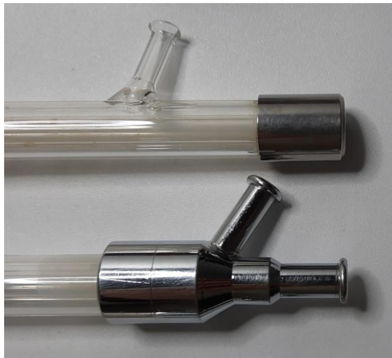
Figure 40 : Détail des raccords en Y des canules de Bommelaer, l'un verre, l'autre « tout métal ». © Coll. de l'auteur.
