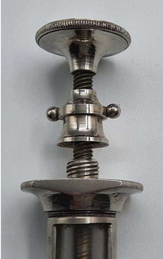
Figure 4 : détail de l'écrou de blocage, permettant de libérer la tige du piston du vissage, ou de calibrer le volume à injecter. © Collection de l'auteur.
