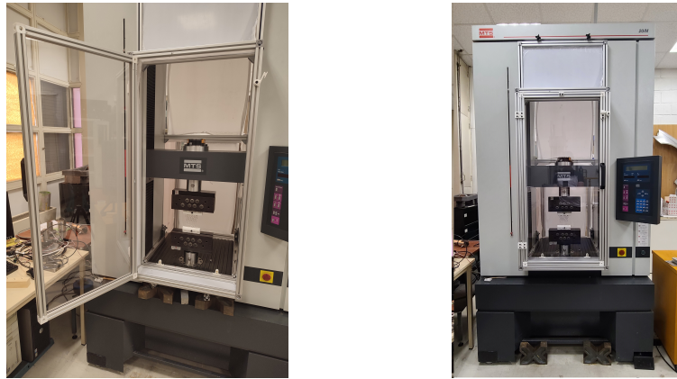
FIGURE 9 – Chambre thermique réalisée pour mieux contrôler la température lors des essais
