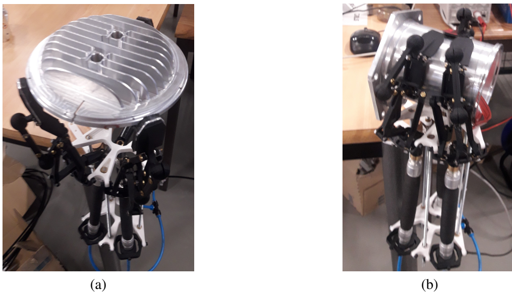
FIGURE 4 – (a) préhension sphérique et (b) préhension cylindrique réalisées avec la nouvelle architecture de doigt et un actionnement avec 3 muscles pneumatiques
