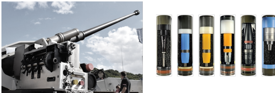
FIGURE 1 – 40 CTAS (à gauche) et gamme de munitions télescopées de 40 mm CTAI (à droite)
