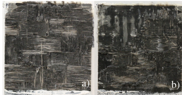
FIGURE 2 – Exemple de (a) rupture cohésive et de (b) rupture mixte cohésive + adhésive
