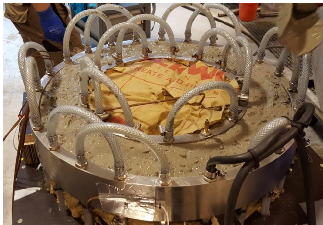
Figure 1: principe de l'essai BTRing avec position des jauges de déformation.
