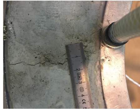
Figure 3 : à gauche, évolution de la contrainte (traction positive) ; à droite, vue de la fissure apparaissant à t=62h .
