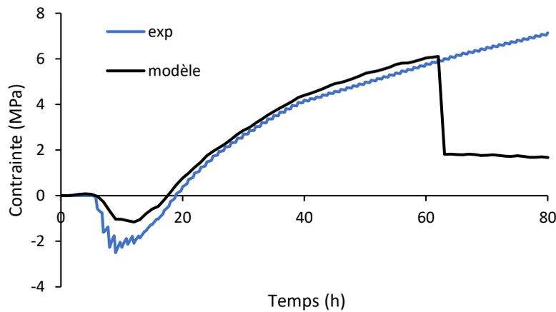
Figure 9 : évolution comparée de la contrainte orthoradiale mesurée et issue du modèle, près de l'anneau intérieur.
