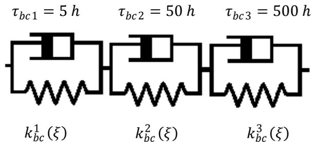
Figure 6 : modèle rhéologique pour la déformation de fluage.
