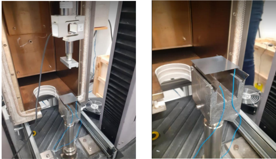
FIGURE 4 – Sollicitation en flexion pure de la plaque en silicium.
