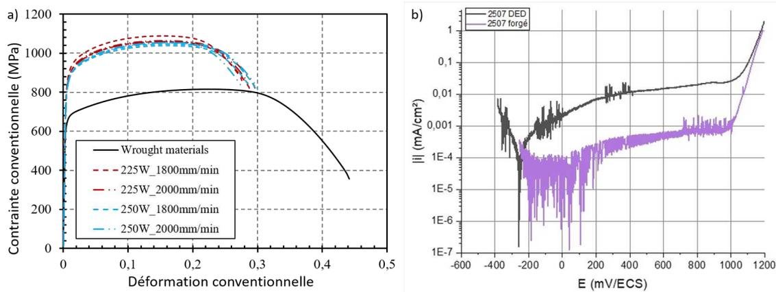
FIGURE 8 – (a) Essais de traction et (b) Courbes de polarisation réalisés sur des échantillons d’acier 2507 forgé et fabriqué par procédé DED (brut de fabrication)
