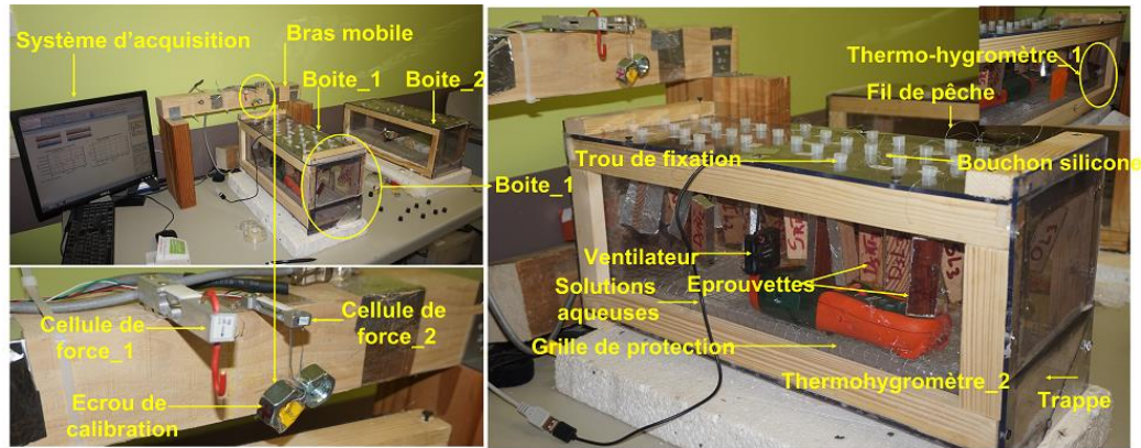
Figure 2 : Dispositif expérimental pour essais de diffusion
