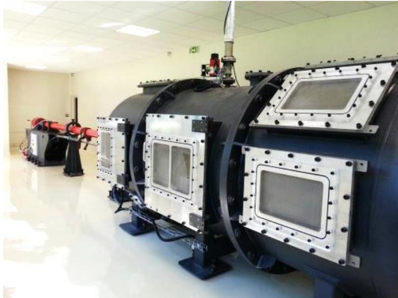
Figure 2 : Lanceur à gaz léger (rouge) et chambre de décompression avec hublots, de la plateforme Experdyn du laboratoire 3SR.
