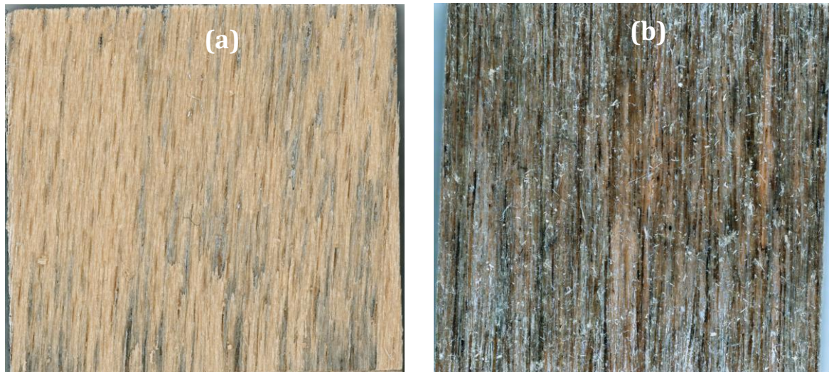
Figure 6 – Faciès de rupture des joints d'adhésif dans des éprouvettes (a) hêtre PP ; (b) hêtre PP renforcé par des fibres de lin.
