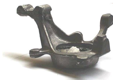
FIG.2 – Porte fusée en acier réalisé par thixoforgeage
