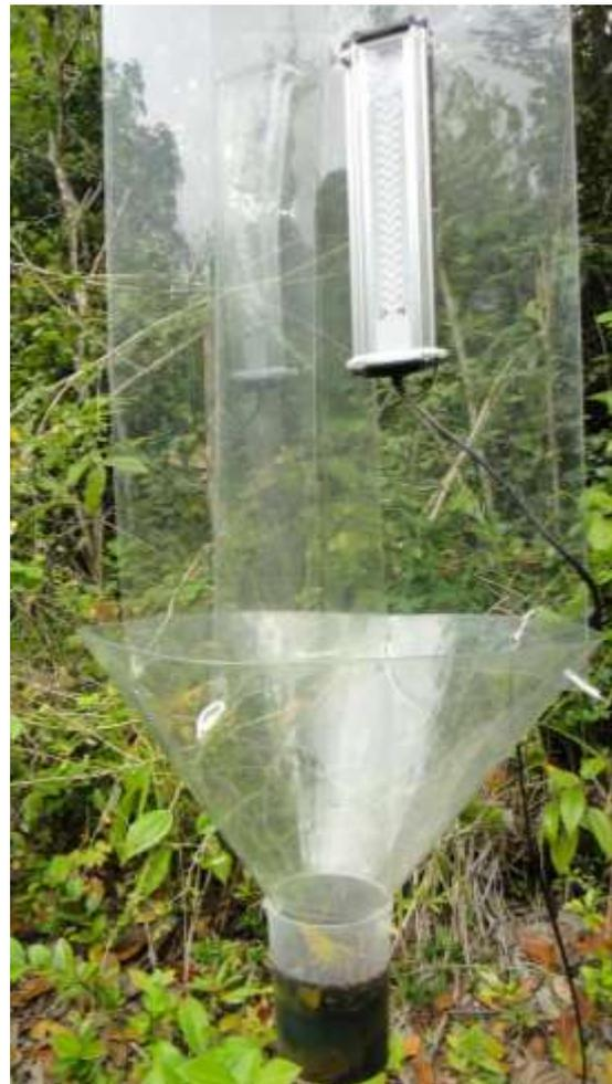
**Fig. 29.** À droite, le modèle PVB avec sa rampe LED qui, depuis 2016, a remplacé un des deux Polytrap (à gauche) utilisé dans chaque zone d'étude.
