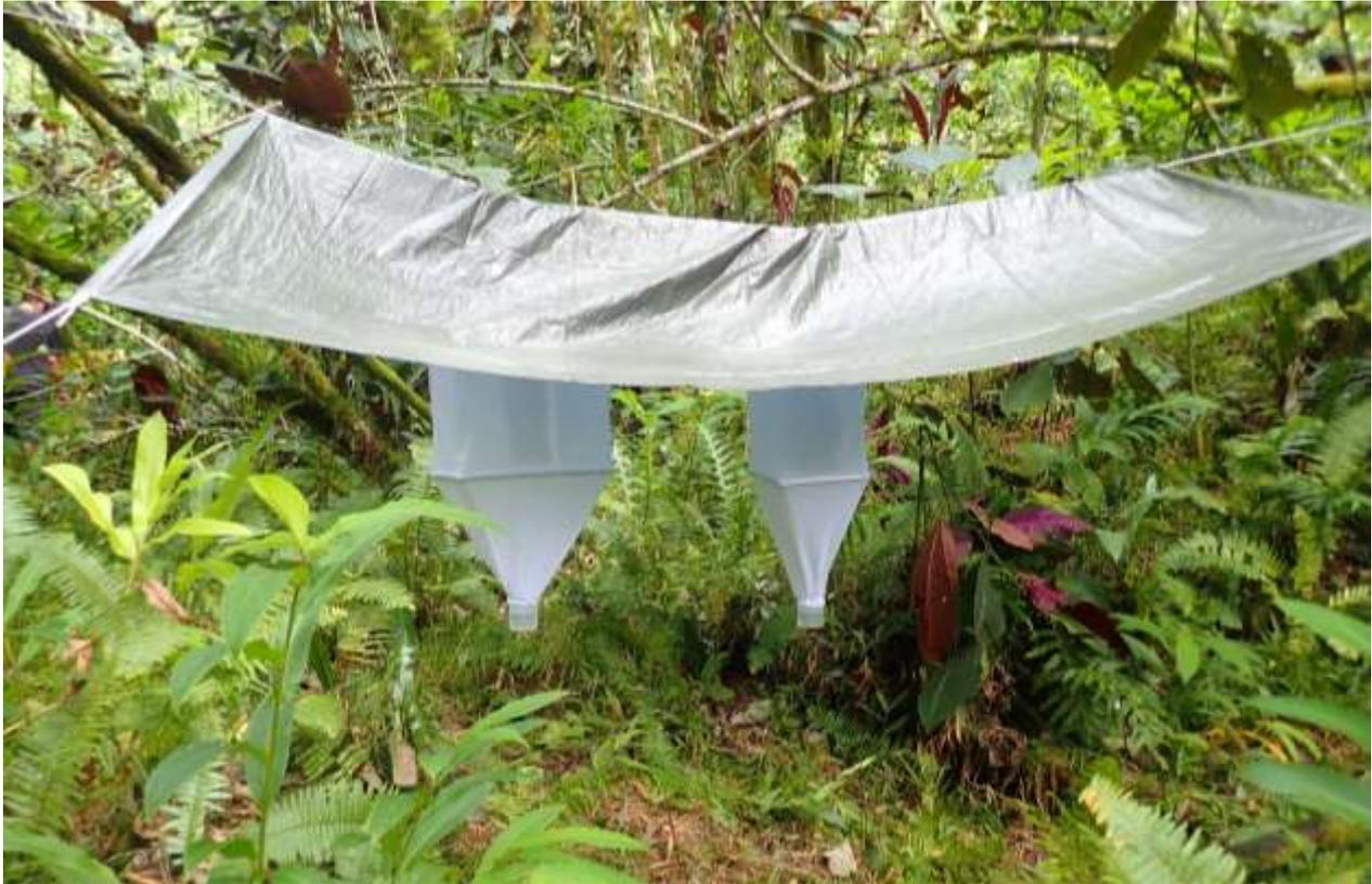
Fig. 20. Installation des MoczarSKI, système permettant d'extraire par séchage les insectes présents dans des échantillons de litière.
