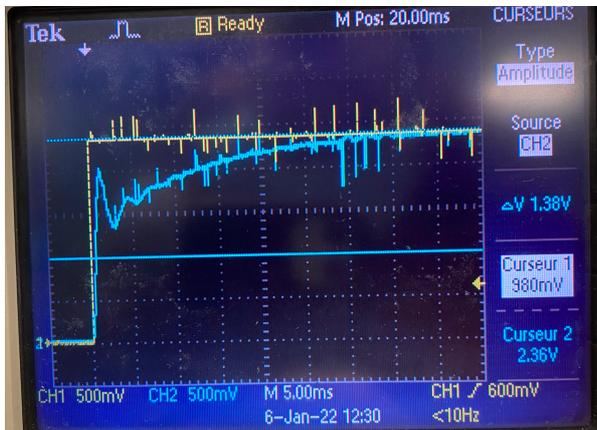
Fig 19 : Réponse du système en BF avec correcteur PI
