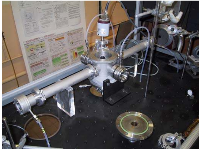
FIG. 1 – Réacteur de synthèse de nanopoudres par pyrolyse laser.
