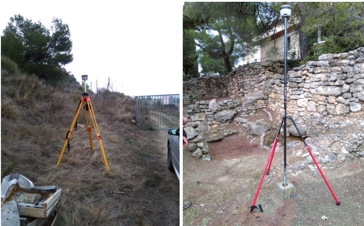
Figure 1: A gauche la base sur trépied Lourd et à droite le mobile en phase d'acquisition sur tripode léger. Ensérune 2021 photos FB
