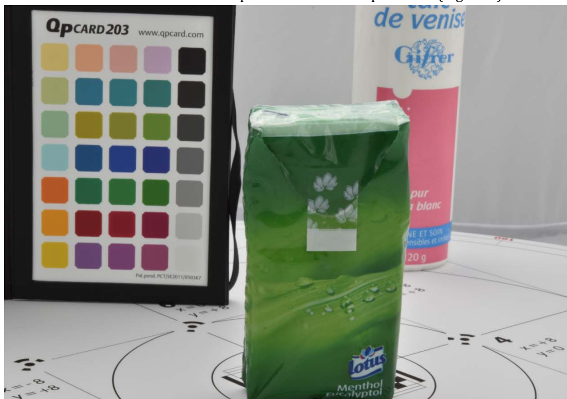
Figure 3 : Mire de calibration Qpccard avec deux objets de couleurs différentes à des distances différentes pour contrôler la profondeur de champs.
