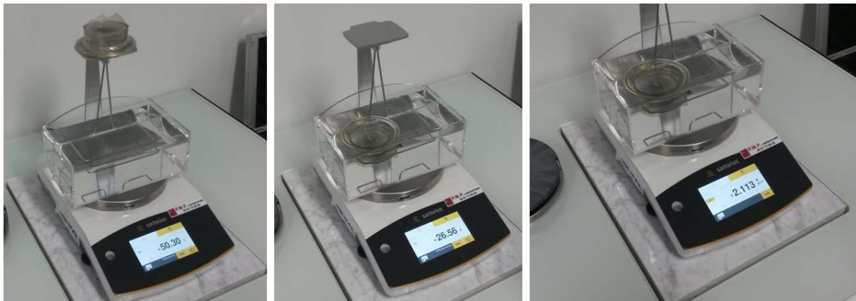
Figure 28 : Mesure du volume et de la masse volumique (à droite) du verre par pesage dans l'air (à gauche) et dans l'eau (au milieu). le volume correspond à la différence entre les valeurs de masse dans l'air et dans l'eau.
