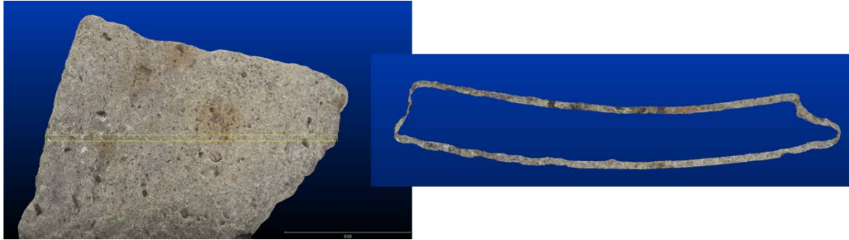
Figure 8 : Découpe d'une lamelle de 1 mm de hauteur dans le nuage de points du fragment 3
