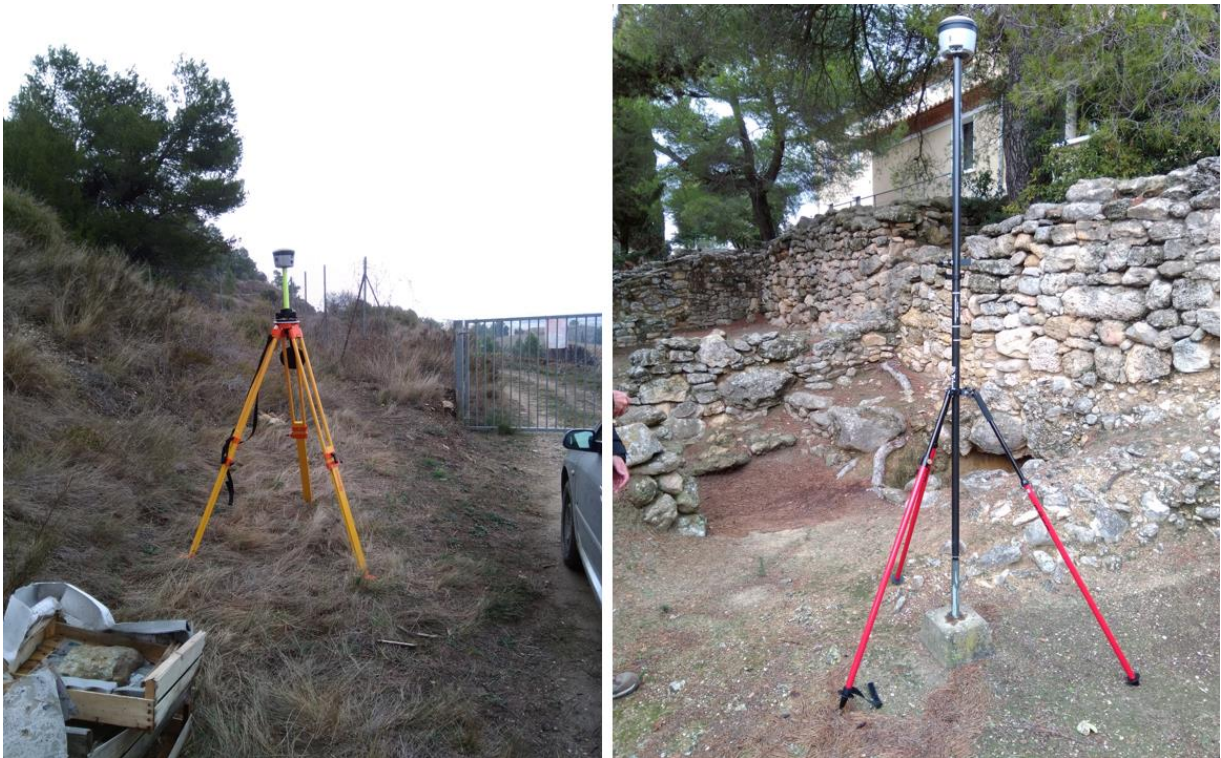
Figure 1 : A gauche la base sur trépied Lourd et à droite le mobile en phase d'acquisition sur tripode léger
