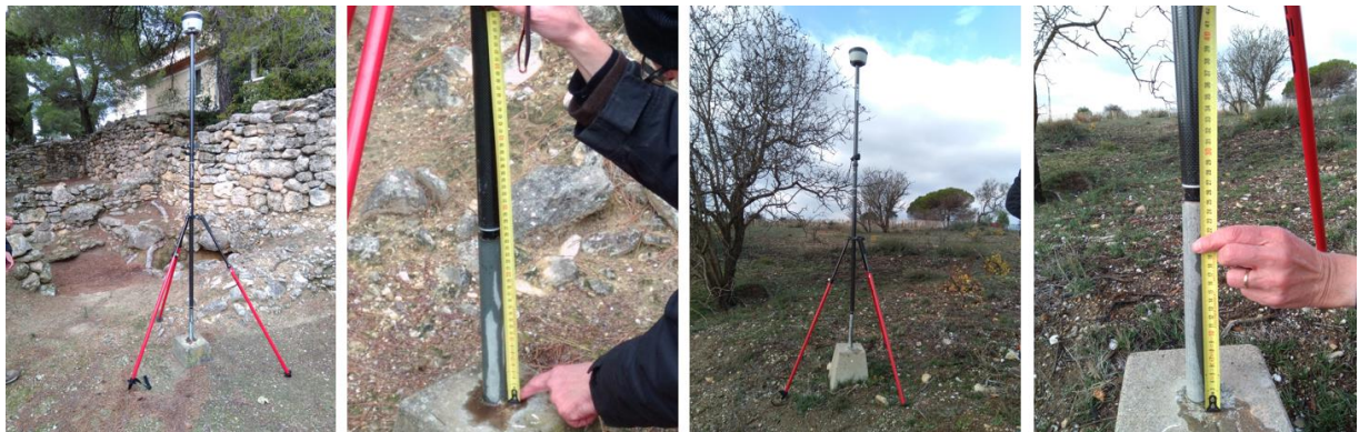
Figure 3 : Exemples de photos prises pour chaque point. Une photo de situation et une photo rapprochée avec un mètre pour déterminer la hauteur.
