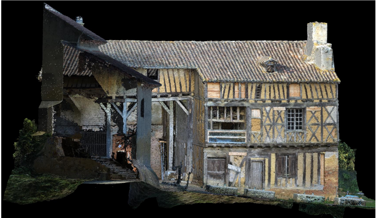
Figure 5 : Sainte Christie d'Armagnac - Mission du 22/11/18 - Nuage de points dense ( \approx 158 millions)
