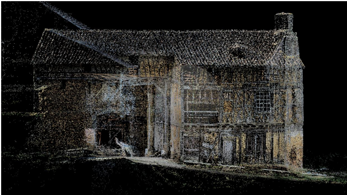
Figure 4 : Sainte Christie d'Armagnac - Mission du 22/11/18 – Nuages de points de liaison
