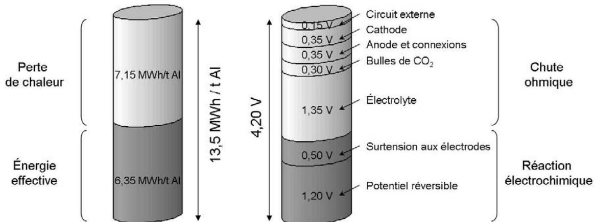
**Figure 7 : Répartition du potentiel de cellule et consommation énergétique**
