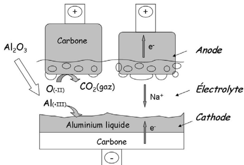
Figure 4 : Schéma de principe de la cellule d'électrolyse
