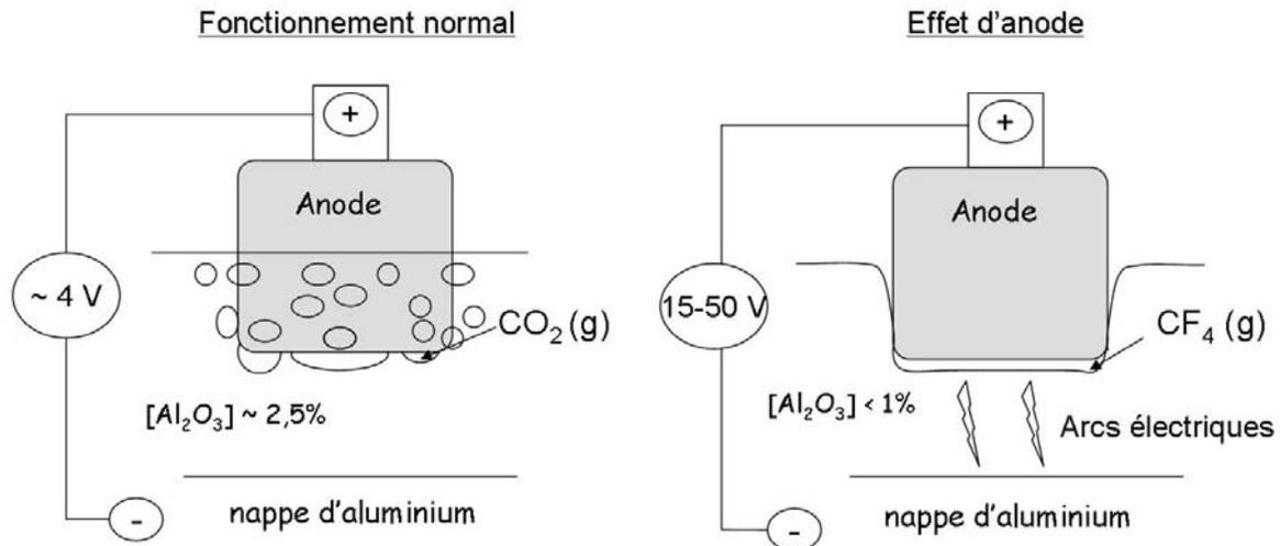
**Figure 8 : Représentation schématique de l'effet d'anode**
