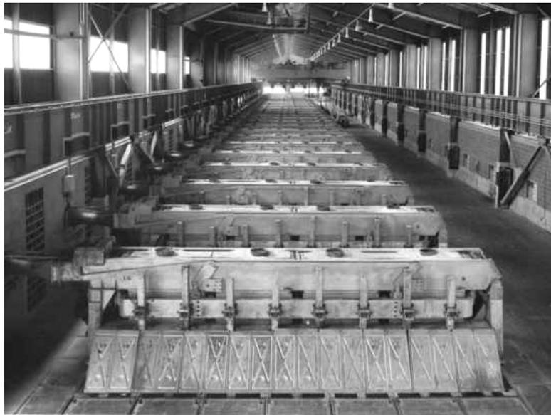
**Figure 6 : Photographie d'une série de cuves d'électrolyse**
