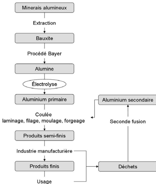
**Figure 1 : Principales étapes de la métallurgie de l'aluminium**
