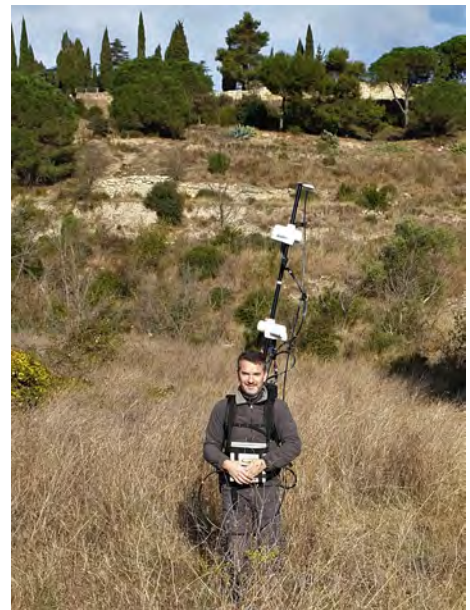
Figure 2: Magnétomètre-gradiomètre GSM-19 en mode "walking" (cliché C. Calastrenc)
